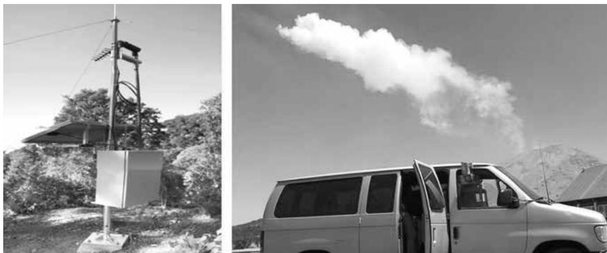
**Figura 8.** A la izquierda se muestra una estación de monitoreo geoquímico instalada en el Popocatépetl, a la derecha se muestra una imagen de una campaña de adquisición de datos para la cuantificación de gases emitidos por el volcán; ambos forman parte del sistema de monitoreo que opera actualmente en el Popocatépetl.
