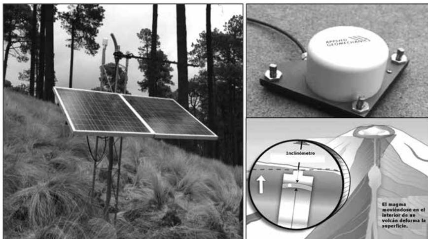
**Figura 7.** Ejemplo de una estación de monitoreo geodésico, a la izquierda se muestra a la estación de monitoreo “Encinos”, a la derecha arriba se muestra un inclinómetro como los que están instalados en el volcán, abajo se muestra el principio que utiliza el inclinómetro para detectar que el volcán está sufriendo una deformación.
