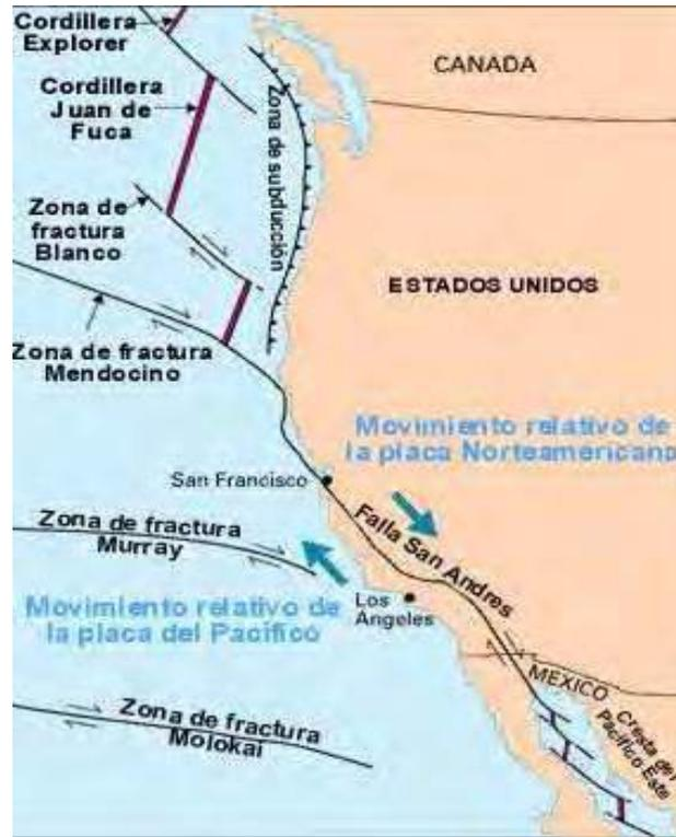
Imagen 8. Situación sismotectónica de la zona. Se muestra con flechas la dirección del movimiento relativo de las placas Norteamericana y del Pacífico, y los sistemas de fallas que disipan ese movimiento.
