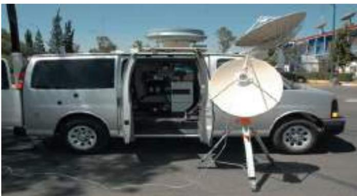
*Fuente: Cofetel. Unidad móvil de radiomonitoring para rastreo de frecuencias nocivas y mantener el uso eficiente del espectro.*
